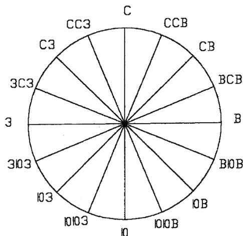
Рис. 4. Схема 16 румбов для определения углов дующих ветров к дороге
